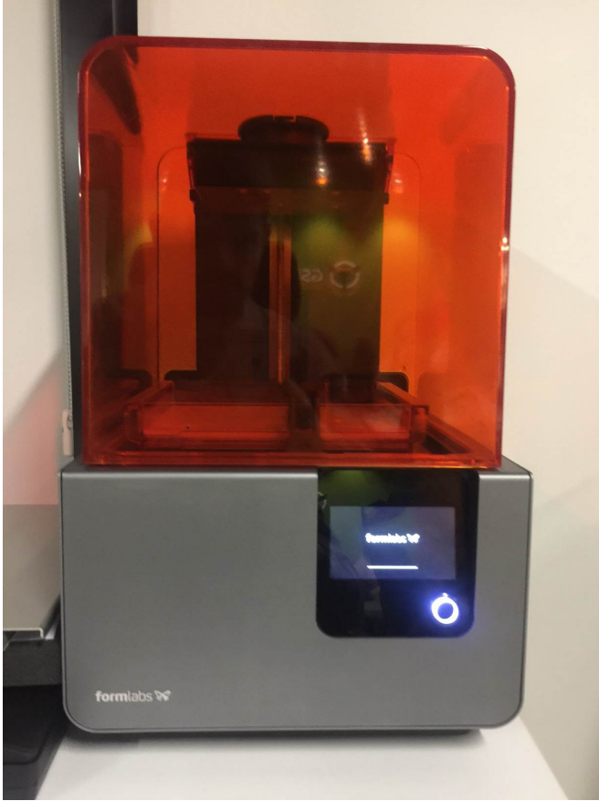
Figura 97. Equipo de impresión 3D por método de esterolitografía para impresión de modelos anatómicos tridimensionales para las múltiples pruebas.
