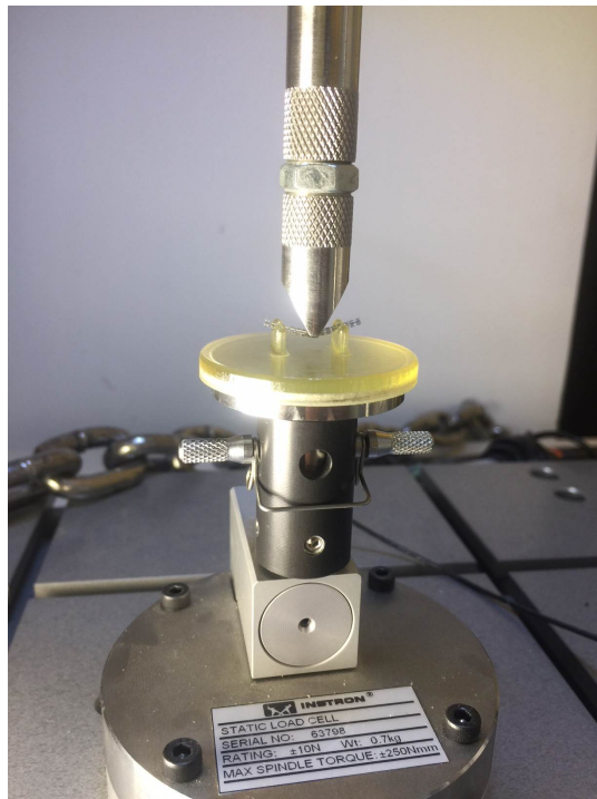
Figura 134. Prueba de flexión en 3 puntos hasta 1 diámetro de flexión. Los resultados arrojaron un valor de hasta 0.37 Newtons ante la compresión de 1 diámetro. Este dato no significa en general un valor bajo o alto en flexión. Es una característica estandarizada del stent. La habilidad de navegar dependerá mucho del radio de curvatura y ángulo de la arteria coronaria.
