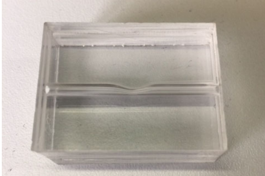
Figura 105. Modelo en acrílico transparente para desarrollo de pruebas de “cruzabilidad” del catéter/stent ante la presencia de un modelo de una obstrucción o estenosis arterial. Los resultados del uso de este aditamento se presentan en secciones posteriores en la sección de los entregables de las instituciones vinculadas.
