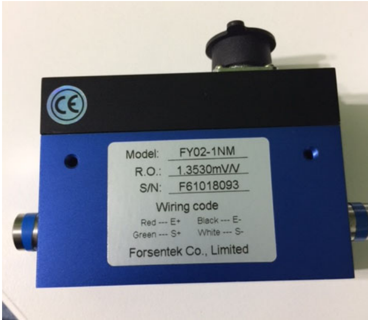
Figura 103. Sensor de torque dinámico de 1NM para realización de pruebas de torque en rotación del catéter dentro de los modelos anatómicos vasculares.
