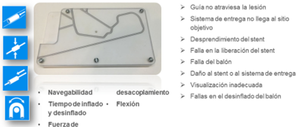
Figura 111. Fabricación de aditamento de acrílico y teflón para evaluación de navegabilidad en tortuosidad coronaria bajo ángulos críticos. Los resultados del uso del aditamento se presentan en secciones posteriores.
