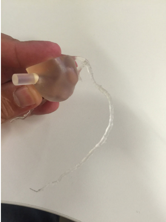
Figura 109. Impresión 3D del modelo de árbol coronario reconstruido mediante imágenes seccionales DICOM de Tomografía AngioTAC para la evaluación de la navegabilidad del stent coronario.
