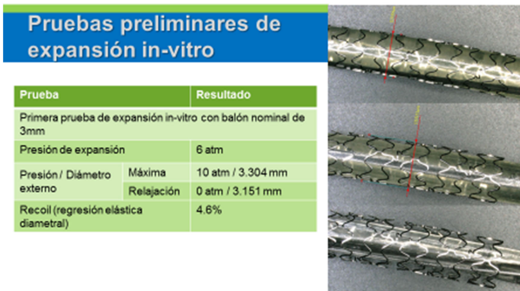
Figura 126. Las pruebas preliminares de expansión indican una presión de expansión de 6 atmósferas con un porcentaje de regresión elástica de 4.6%. Ambos datos aceptables para un stent coronario.
