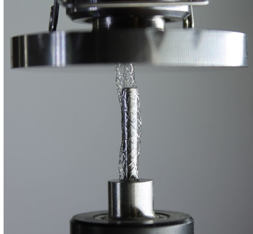
Figura 138. Final de la prueba de resistencia de compresión longitudinal mediante la prueba estandarizada ISO 25539-2 para evaluar la resistencia a la deformación longitudinal durante el proceso de colocación del stent en la placa aterosclerótica.
