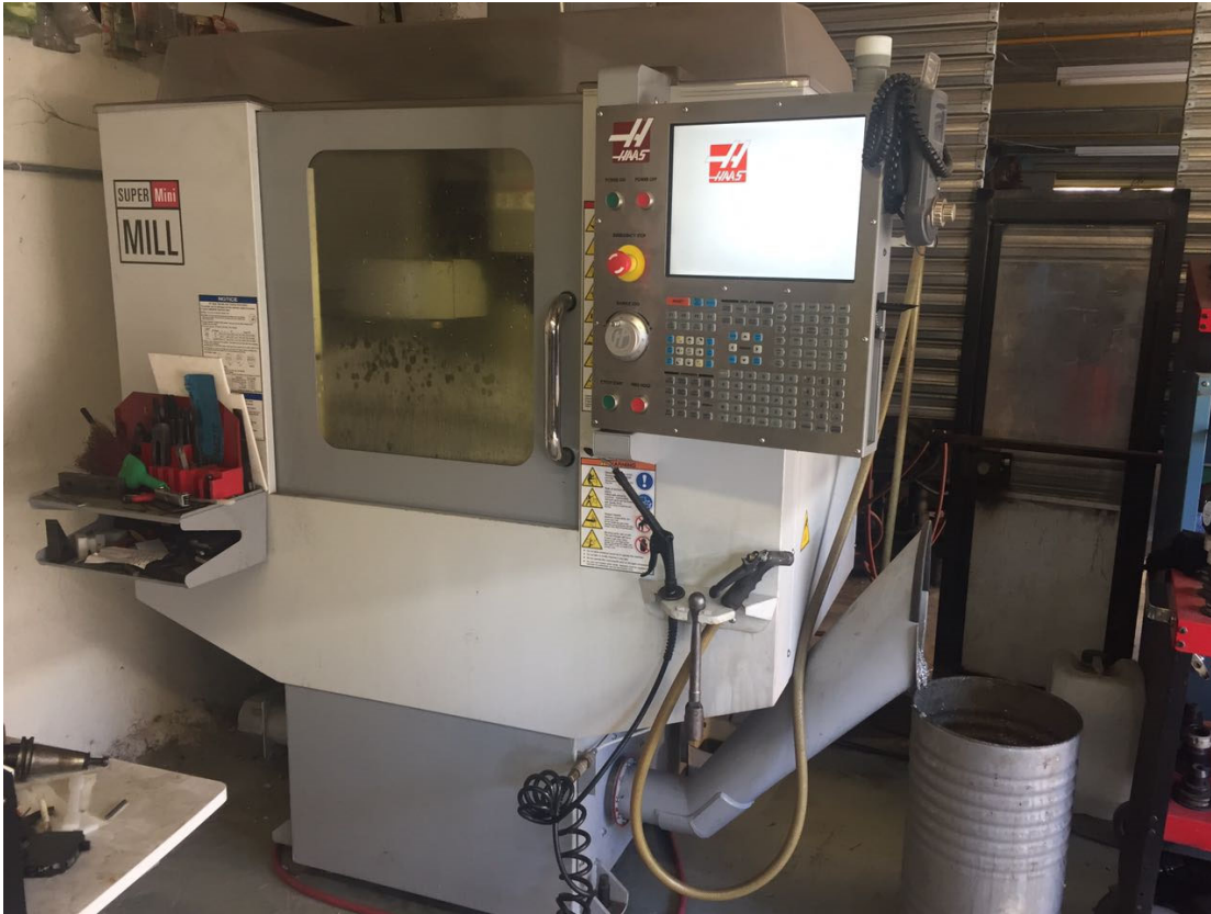
Figura 96. Centro de maquinado para fabricación de los múltiples aditamentos especializados para el desarrollo de pruebas experimentales de los stents.
