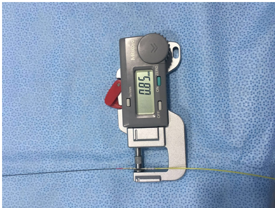
Figura 122. Verificación del diámetro final del ensamble del stent sobre el balón. En los resultados se obtuvo un promedio de 0.85mm. Los pasajes de oclusión arterial ante la presencia de una estenosis oscilan entre 1.2 hasta 2.5mm de diámetro, así que el ensamble cabe perfectamente.
