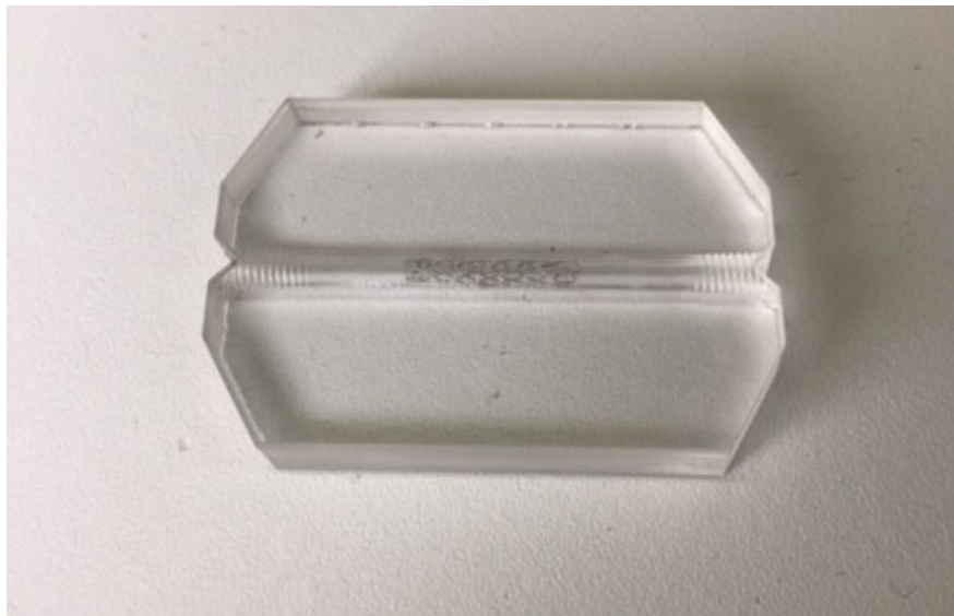
Figura 104. Modelo de acrílico transparente para colocación del stent coronario en diámetro de 3.2mm para visualización de partículas. Los resultados del uso de este aditamento se presentan en secciones posteriores.
